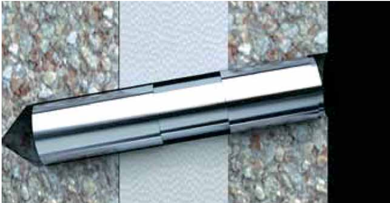
Panelkéreg megerősítése speciális kónuszos nemesacél csappal
