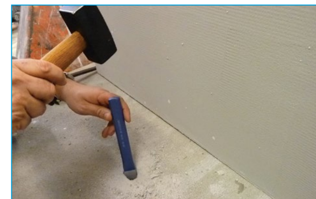
Mintavétel az aljzatból, a vizsgálandó anyag összegyűjtése, porítása, majd tömegmérése
