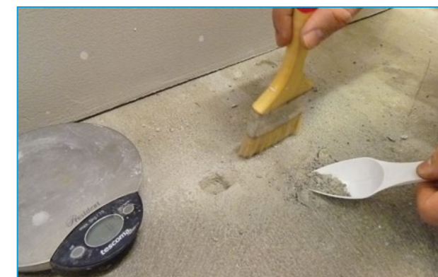
Mintavétel az aljzatból, a vizsgálandó anyag összegyűjtése, porítása, majd tömegmérése
